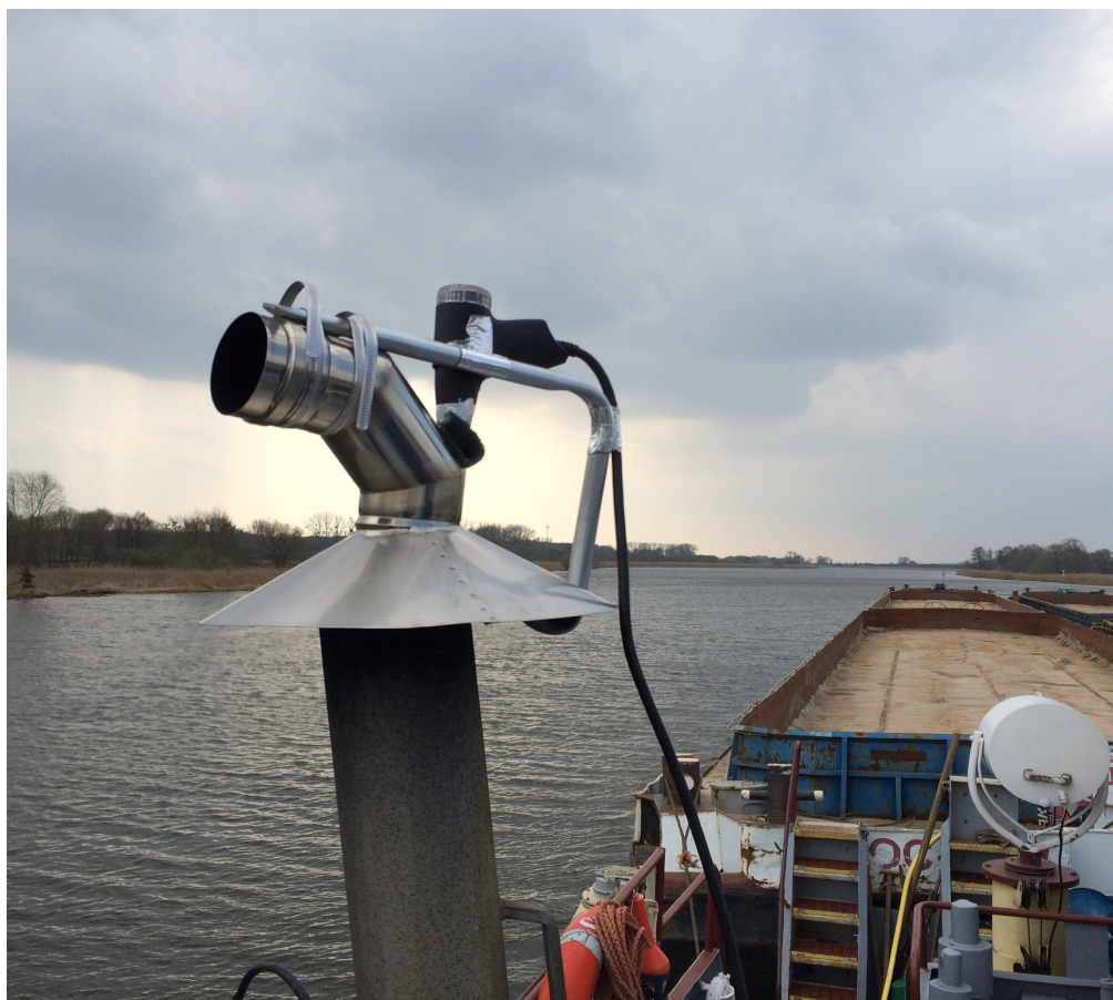
Rys. Specjalna konstrukcja kołnierza pod sondę analizatora spalin
